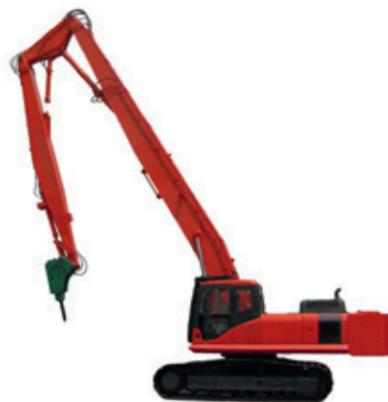
Конструкция оборудования разработана с учётом требований транспортных габаритов ПДД (высота, длина, и т.д.), что позволяет перевозить экскаватор, не демонтируя стрелу.
