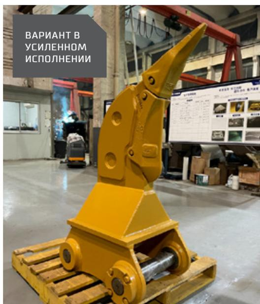
**КЛЫК-РЫХЛИТЕЛЬ** предназначен для разрыхления мерзлоты, прямой добычи полускальных грунтов, демонтажа фундаментов и перекрытий, а также для извлечения из грунта пней, деревьев и крупных камней.
