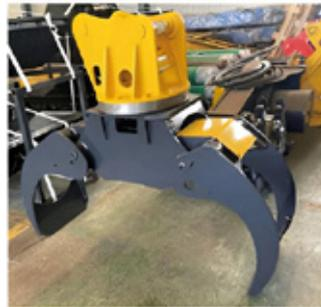
**ГИДРАВЛИЧЕСКИЙ ЗАХВАТ ДЛЯ БРЕВЕН** в основном используется в подъемном механизме экскаватора, телескопическом манипуляторе и автокране, в основном в лесном хозяйстве. Он в основном используется для захвата длинных полос материалов, таких как ветви, стволы деревьев, сахарный тростник, бамбук и т.д. Он больше подходит для захвата относительно небольших материалов и в основном используется для легких строительных работ.
